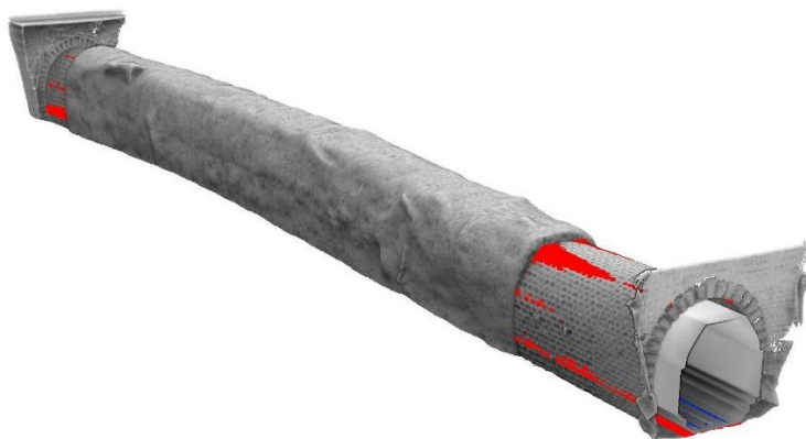
Obr. 1 Průkaz prostorové průchodnosti na 3D modelu (Žďárský tunel)
